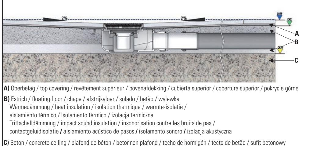
**A)** Oberbelag / top covering / revêtement supérieur / bovenafdekking / cubierta superior / cobertura superior / pokrycie górnego
